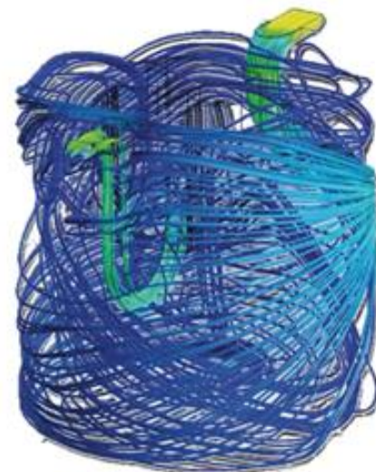
Wizualizacja przepływu wewnątrz separatora.
